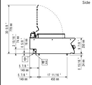
D Drain Electrical inlet (power) ΕI Equipotential screw Water inlet
